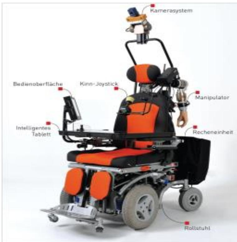
Abbildung 21: FRIEND-Roboter
